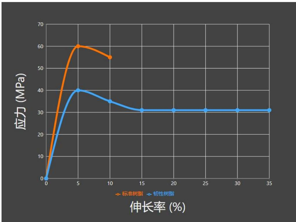
一般而言，曲线的横坐标（x 轴）是应变，纵坐标（y 轴）是外加的应力。为了工程的需求，一般会假设材料在整个拉伸过程中，其截面积不会变化，不过在变形过程中，截面积也会略为变小。在假设截面积不变的条件下所画的应力-应变曲线称为“工程应力-应变曲线”，考虑真正截面积变化的应力-应变曲线称为“真应力-应变曲线”。
