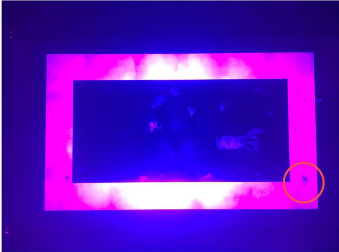
一般来说，这种损坏是可逆的，在静置冷却后，如下图所示，LCD 屏幕的大部分都已恢复正常。但是在持续发热工作中，仍可能因为温度过高损坏 LCD 屏幕，直至不可逆。
